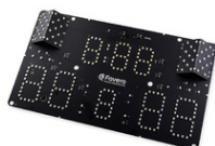
Art.0435-4350 SL SCH F1805 + F1806 tarjeta LED+zumbador para FA-15
