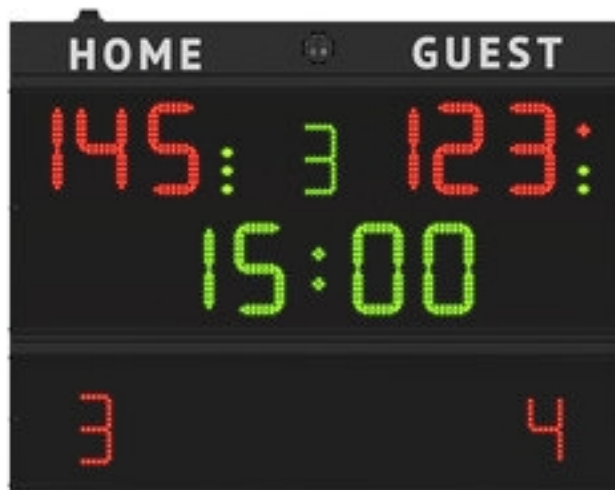
Art.3045420 FC54H20 Modell Anzeigetafel FC54, Ziffernhöhe 20cm. Abmessungen: 140x108x9cm. - Gewicht: 30kg.
