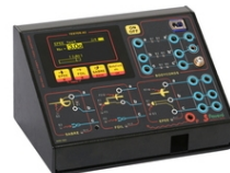
Art.899-02 TESTER-A2 professionelles Prüfgerät für den Fechtsport Abmessungen: 21,0x12,0x14,0cm. - Gewicht: 2,5kg.
