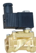
Art.199-20 Electroválvula 12Vcc 8W max, G1/2 Hembra-Hembra, ISO-228 Dimensiones: 6x4xH10cm. - Peso: 0,50kg.
